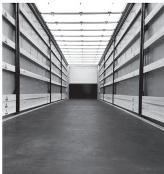
лей, стоек, задних распашных ворот и сдвижной крыши. Между передним бортом и стойками, между стойками, между стойками и задними воротами устанавливаются деревянные или алюминиевые планки и/или алюминиевые откидные и съёмные борты.
