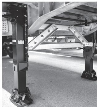
Опорное устройство состоит из правого и левого опорных устройств, связанных между собой валом и рукоятки, которая устанавливается на хвостовик редуктора. Правое опорное устройство отличается от левого наличием дополнительного редуктора, обеспечивающего ускоренный подъем и опускание до соприкосновения опорных плит с землей, а также замедленного подъема и опускания при нагруженных опорных устройствах.
